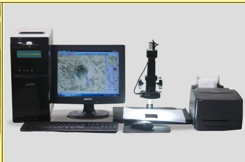
Medición con microscopio electrónico del diámetro de la marca (laboratorio Ultiheat)
